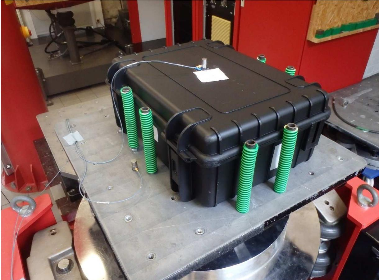
**Bild 5:** Setup Vibrationsprüfung
